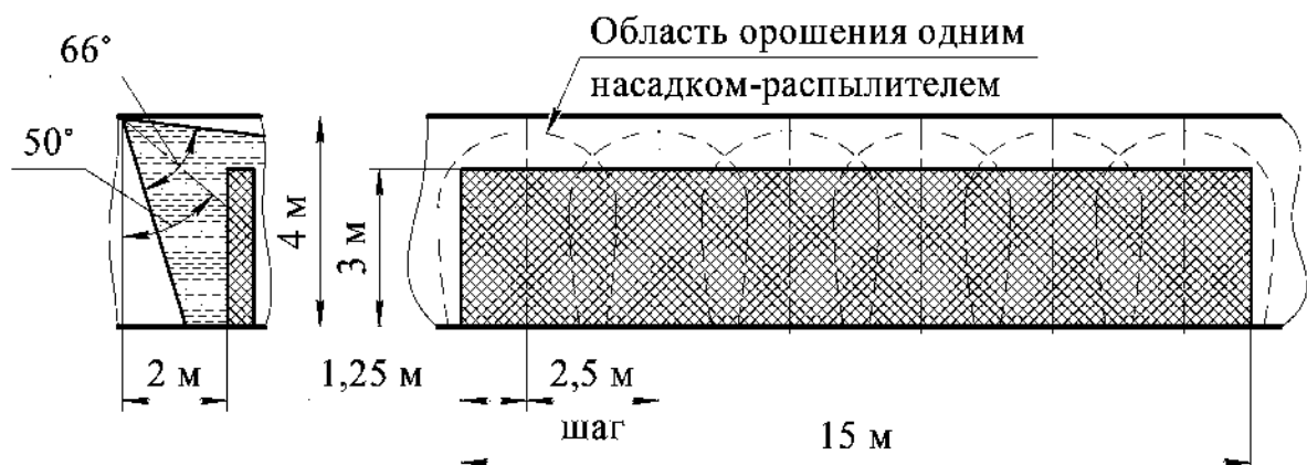
Рисунок 16 - Противопожарная защита боковой поверхности стеллажа 6-ю насадками-распылителями
