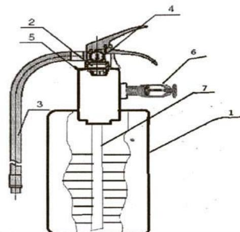
Запорно - пусковое устройство (ЗПУ) (2) ввертываемое на резьбе в горловину баллона состоит из:
