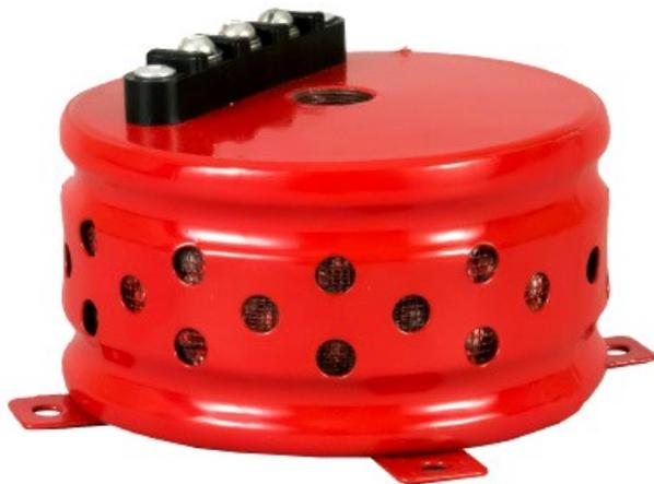
Генератор состоит из корпуса, в котором размещена шашка из аэрозолеобразующего состава, и узла запуска. Шашка из аэрозолеобразующего состава отделена от верхней крышки и дна корпуса теплозащитным материалом.
